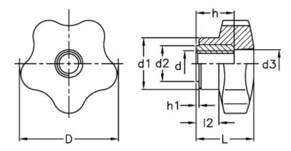
$$\begin{array}{lll} D & = 60 & | 12 = 18 \\ d1 & = 27 \\ d2 & = 17 \\ d3 & = 15 \\ d6H = M14 \\ h & = 26 \\ h1 & = 1.5 \end{array}$$
